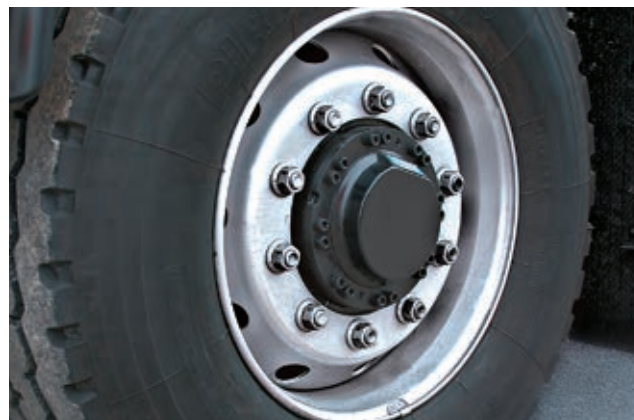
Asse anteriore con motori idrostatici nei mozzi ruota
